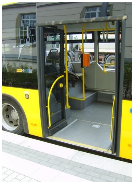
Rys. 7.2. Przerwa między peronem przystankowym a autobusem.
