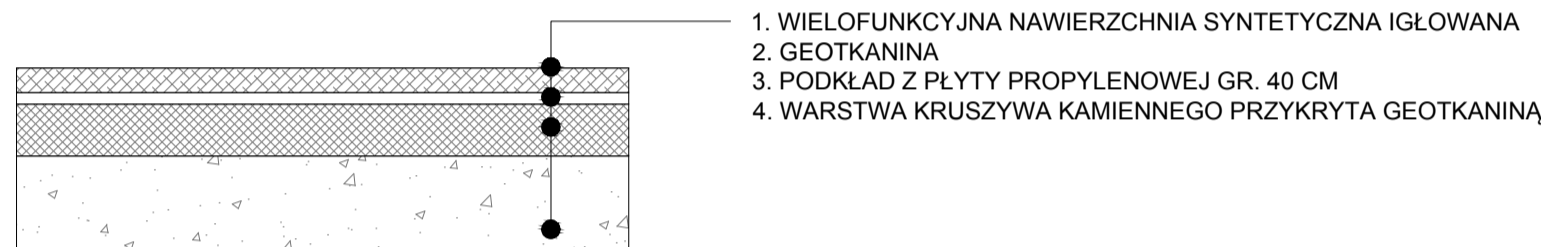
SCHEMAT 3. PRZEKRÓJ PRZESZCZYNIA SYNTETYCZNA DLA STREFY REKREACYJNEJ
