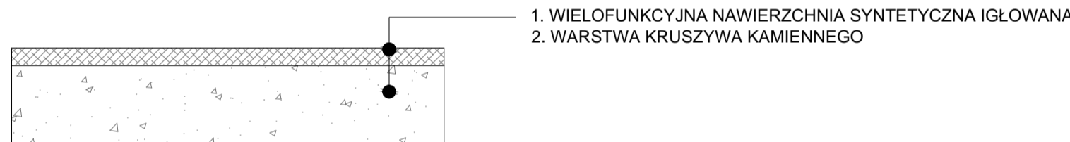
SCHEMAT 3. PRZEKRÓJ PRZESZCZYNIA SYNTETYCZNA DLA STREFY REKREACYJNEJ
