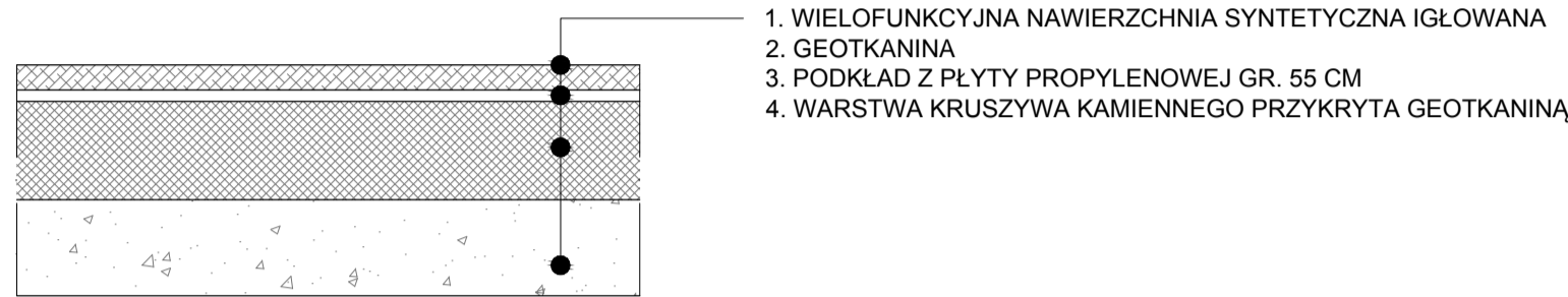
SCHEMAT 2. PRZEKRÓJ PRZESZCZYNIA SYNTETYCZNA DLA STREFY UPADKU HIC = 130 CM
